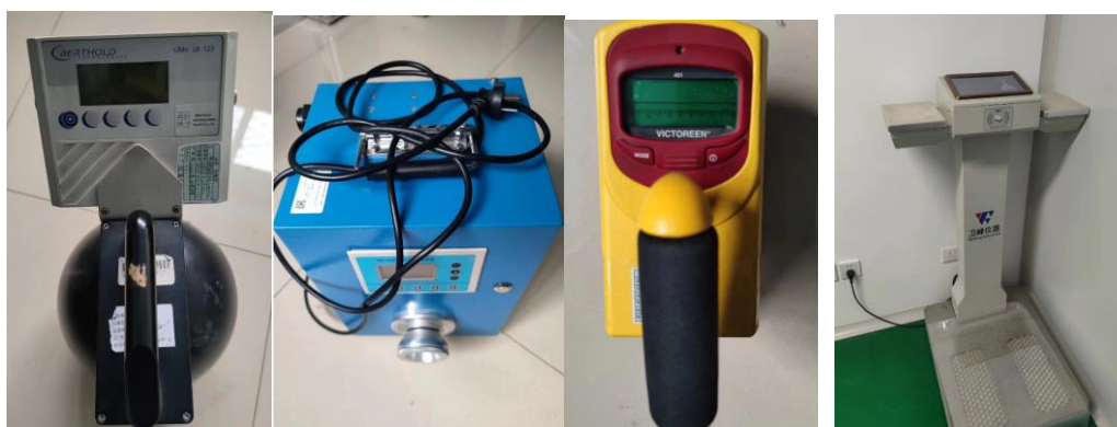
图 4-39 本项目配备的部分便携式监测仪表、手脚沾污仪及空气取样泵照片
