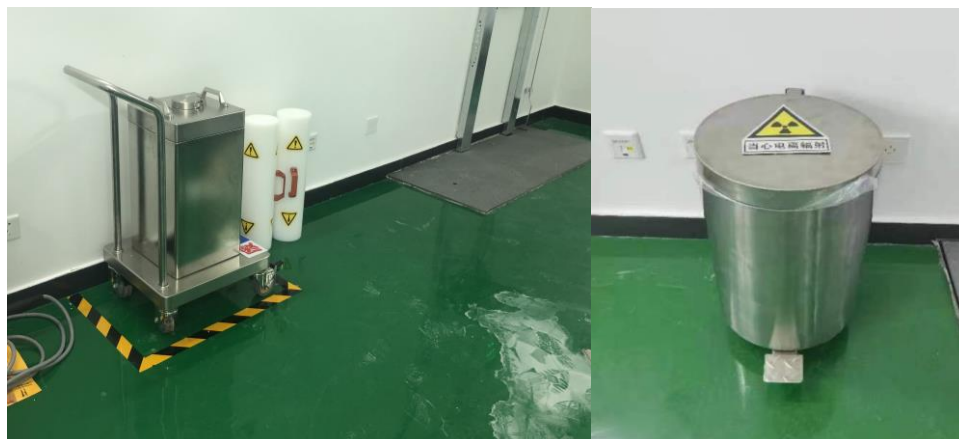
图 4-32 加速器大厅铅桶现场照片
