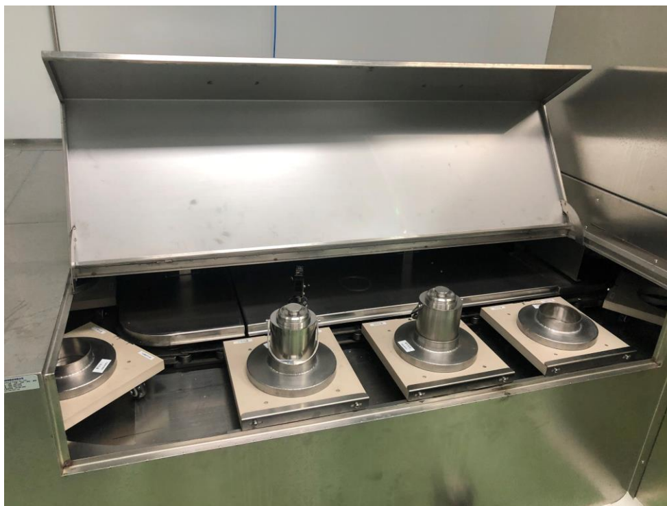
图 4-9 防护罐现场图
